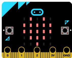
Se compone de un panel de leds, un sensor de movimiento, uno de luz un termómetro, una brújula, un par de botones...etc. Todo esto nos permite mediante un programa muy simple, crear imágenes, hacer pequeños juegos y muchas mas cosas
